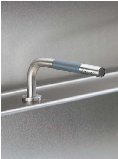
T1 Utdragbar handdusch med slang. Bänkjocklek: Max 45 mm. Håltagningsmått: 30 mm.
